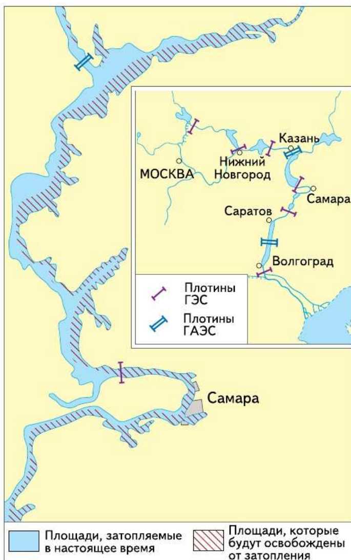
Рис. 88. Проект перестройки Волжского каскада ГЭС
