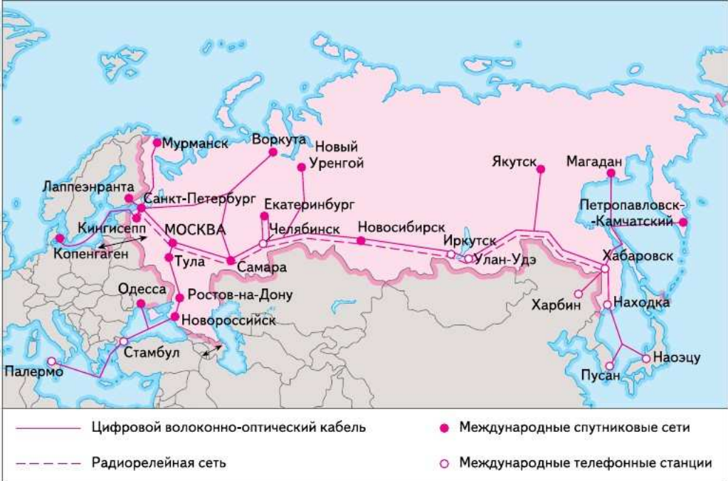
Рис. 28. Трансроссийская система волоконно-оптической связи
